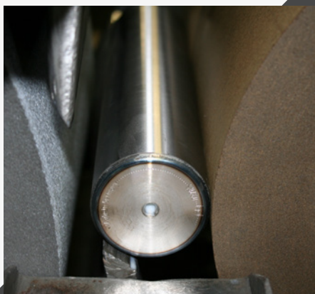
Slijpen, gevolgd door langdurige corrosiebescherming
